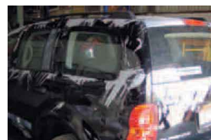
Остатки клея на поверхности после удаления пленки
